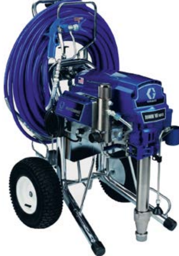
Рис. 5 – Аппарат для безвоздушного распыления
